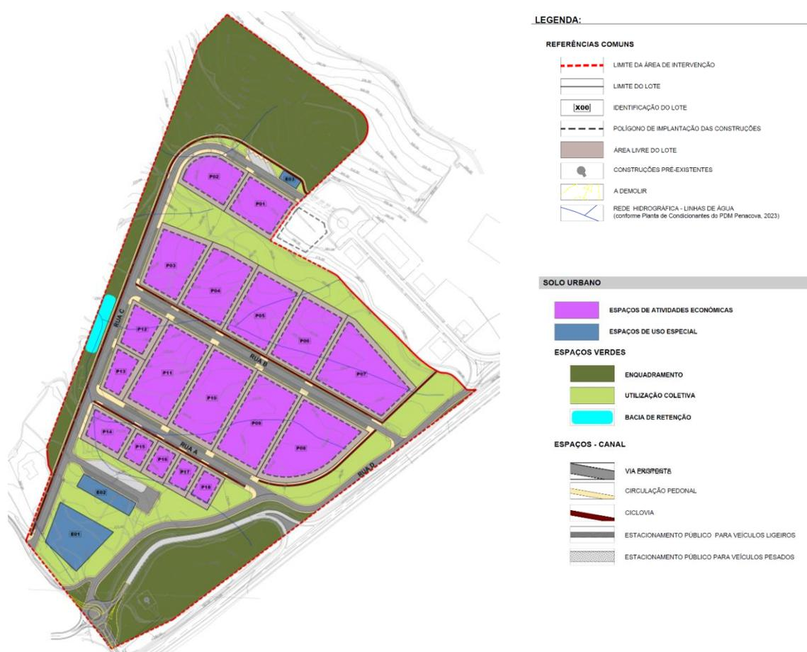
Figura 4. Planta de Implantação do PP Ampliação do Parque Empresarial de Alagoa
